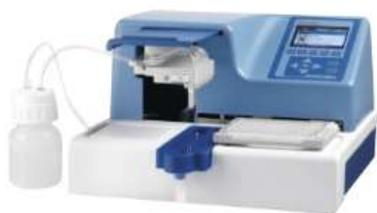
Диспенсер Multidrop Combi nL выполнен в виде компактной платформы с дозирующим модулем, площадкой для установки планшетов, герметичным сосудом для работы под давлением, обратной промывкой и сбросом лишних реагентов в сторону раздаточной ёмкости. Аппарат работает с микролуночными планшетами разного формата и комплектуется цветным сенсорным дисплеем с графическими иконками для быстрого выбора требуемого режима работы.
