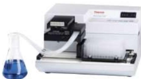
Диспенсер Multidrop DW выполнен в виде компактной платформы с перемещающейся кареткой для установки планшетов и оборудован дозирующим модулем, соединённым с распределительной колбой с помощью отдельных шлангов для каждого канала. При необходимости сброс лишней жидкости осуществляется в сторону раздаточного сосуда, что позволяет сохранить ценные реагенты. Заполнение 96 лунок по 20 мкл каждую занимает 5 сек.
