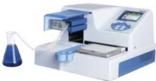
Диспенсер Multidrop Combi оборудован в виде компактной платформы для установки планшетов с помощью роботизированных систем или вручную. Отдельно размещается узел дозирования, комплектуемый одним или двумя небольшими 8-канальными съёмными модулями для наполнения планшетов разного формата. Аппарат оборудован цветным дисплеем с удобным меню в виде иконок для выбора размера пластин и объёма раздаваемых реагентов.
