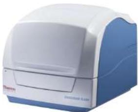
Многофункциональный планшетный анализатор Varioskan Flash работает с любыми доступными планшетами от 6 до 1536 лунок. Прибор поддерживает установку трёх дозировочных модулей для реагентов, вводимых на любой стадии исследования, проводит встряхивание и инкубацию образцов. Аппарат настраивается на изучение образцов при фотометрии, флуоресценции, люминометрии и проводит флуоресценцию с разрешением по времени.
