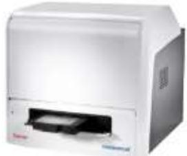
Мультимодальный ридер Varioskan LUX оборудован встроенным модулем для управления подачей газов и определения поглощения клетками кислорода и углекислого газа. Прибор имеет встроенный шейкер и инкубатор для оптимальной подготовки образцов, может комплектоваться двумя диспенсерами для подачи реагентов. Аппарат оборудован монохроматной оптикой и фильтрами, имеет модульную конструкцию.
