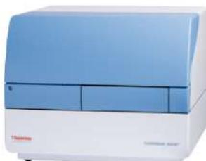
Планшетный флуориметр Fluoroskan Ascent оборудован оптической системой, создающей яркий направленный луч. Диаметр светового потока фиксируется в двух положениях – 1,5 и 3 мм. Аппарат комплектуется несколькими диспенсерами для ввода реагентов с минимальным мёртвым объёмом и об-
