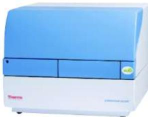
Планшетный люминометр Luminoskan Ascent осуществляет быстрое считывание 96-лунного планшета всего за 15 секунд. Прибор используется для изучения кинетики ферментных процессов и фагоцитоза. Для введения реагентов устанавливается от одного до трёх дозаторов с минимальным мёртвым объёмом и обратной промывкой. Предусматривается введение и одновременное считывание для сбора информации непосредственно с начала реакции.
