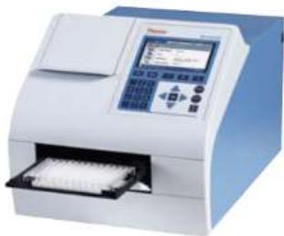
Микропланшетный/кюветный спектрофотометр Multiskan GO оборудован отдельными отсеками для установки приложений, совместим с кюветами и многолуночными планшетами любой пропускной способности. Аппарат работает в УФ и видимой области, имеет карусельный держатель фильтров, поддерживает быструю смену форматов и тратит не более 10 сек для считывания или полного сканирования.
