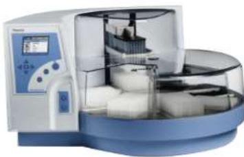
Процессор магнитных частиц KingFisher Flex выполнен в виде вместительной платформы, оборудованной ротационной площадкой для размещения микропланшетов, и устройством для извлечения целевых молекул с помощью 24 или 96 магнитных стержней. В процессе частицы проходят изменение структуры, агломерацию с помощью намагничиваемых включений, инкубацию, промывку, очищение и сбор в одном планшете.
