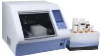
Процессор магнитных частиц KingFisher Duo применяется в подразделениях с небольшой пропускной способностью и отлично справляется с очищением крупных частиц. Во время извлечения целевые молекулы собираются из всех лунок в одну, проходя инкубацию, агломерацию, промывку и очищение. Процесс проходит в автоматическом режиме, необходимо только установить заполненный планшет или одноразовый стрип в рамке и запустить процесс.
