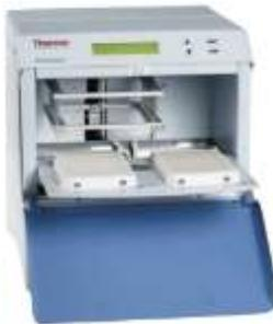
Процессор магнитных частиц KingFisher выполнен в виде автоматического аппарата, осуществляющего извлечение необходимых молекул с помощью намагничивающихся частиц и магнитных стержней. Собираемые частицы агломерируются в процессе инкубации, очищаются, промываются, помещаются в отдельную лунку. Процесс извлечения происходит в микролуночных планшетах или одноразовых стрипах и занимает 20 минут при обработке 24 проб.
