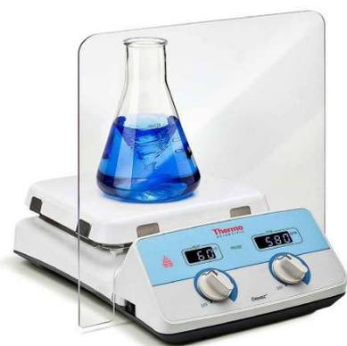
Линейка магнитных мешалок Cimarec+ позволит перемешивать образцы в широчайшем диапазоне объемов: от кюветы для спектрофотометра до 6 л образца. В линейке есть моно- и мультипозиционные модели. Скорость перемешивания варьируется от 80 до 2000 об/мин. Линейка содержит как обычные модели магнитных мешалок, так и приборы, которые можно устанавливать в водную среду для дополнительного термостатирования образцов.
